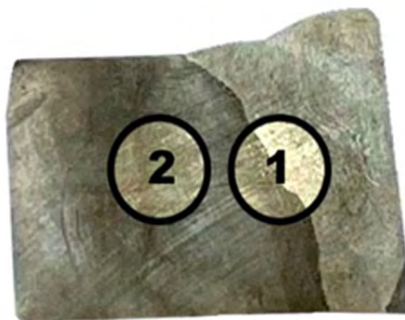
Рис. 1. Области исследования микроструктуры сварного соединения: 1 – зона термического влияния и линия сплавления; 2 – зона основного металла
