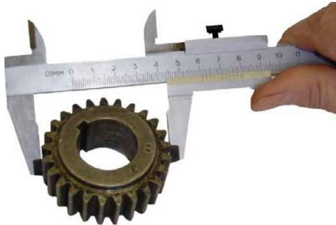
Рисунок 16.3 – Замер диаметра выступов колеса зубчатого
