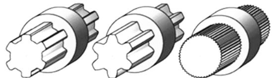
Рисунок 13.2 – Профиль зубьев шлицевого соединения
