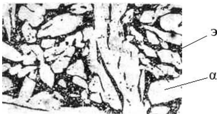
Рисунок 8.5 – Микроструктура литой бронзы БрА10
