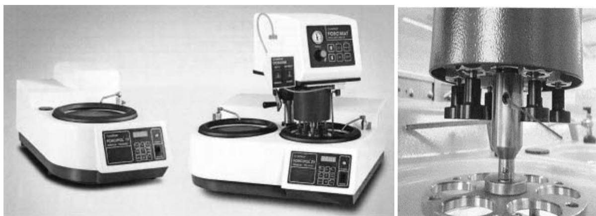
Рисунок 3.1 – Шлифовально-полировальная машина FORCIPOL IV с автоматической головкой FORCIMAT
