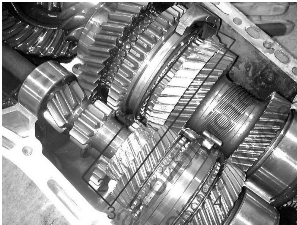
Рис. 3. Повреждение коробки передач при несвоевременном обнаружении облома зуба
