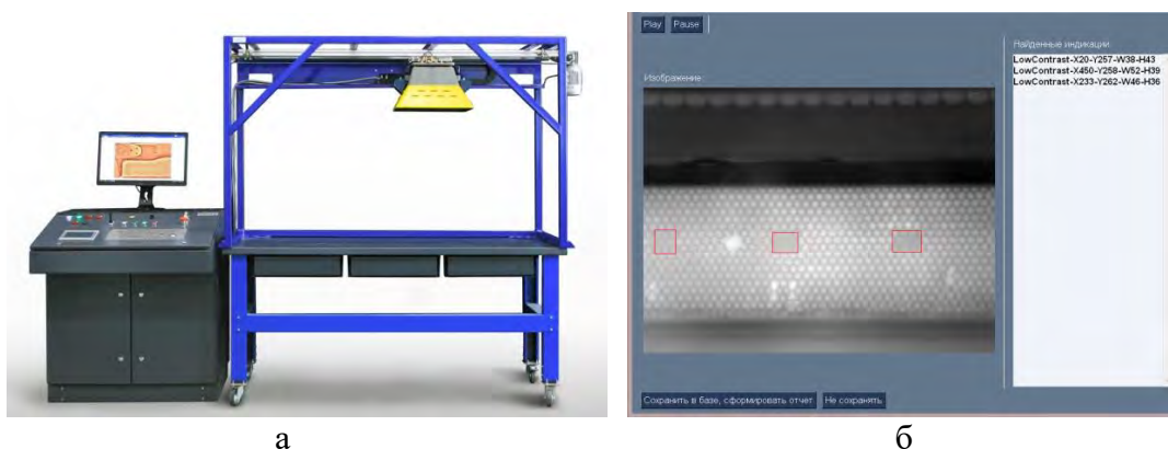
Рис. 2. Система ATK лопастей «Локотерм-В»: а – Общий вид; б – окно ПО «Ассессор Термо» с выделением выявленных дефектов
