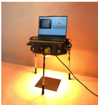
Рис. 4. Система оперативного эксплуатационного АТК воздушных судов «Локотерм. Компакт»
