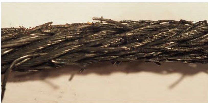
Рис. 1. Участок каната с множественными обрывами проволок
