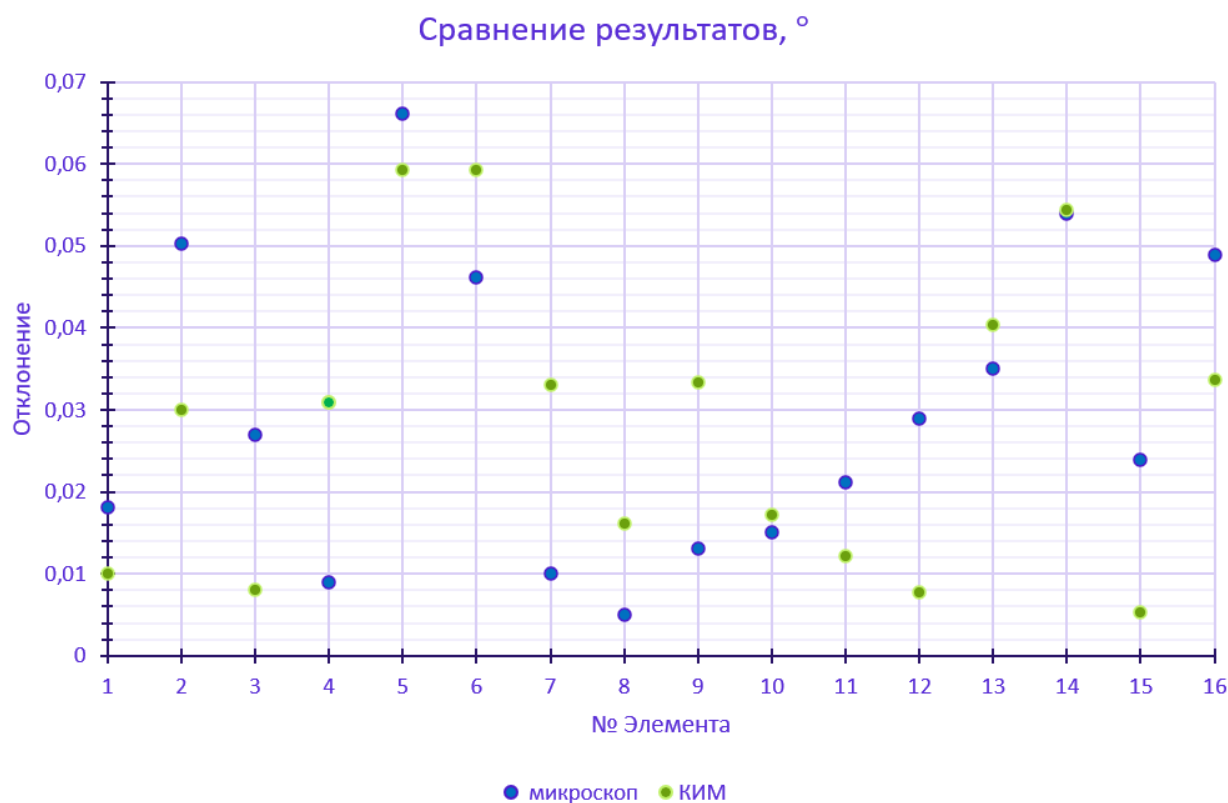
Рис. 4. Точечная диаграмма отклонений для угловых размеров
