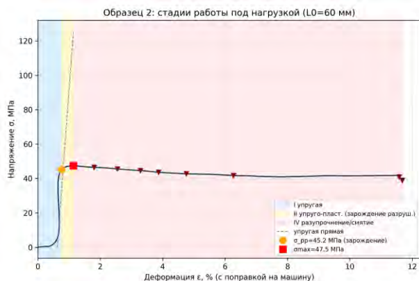
Рис. 4. Стадии работы образца под нагрузкой (образец 4.8, L_0=60 мм)
