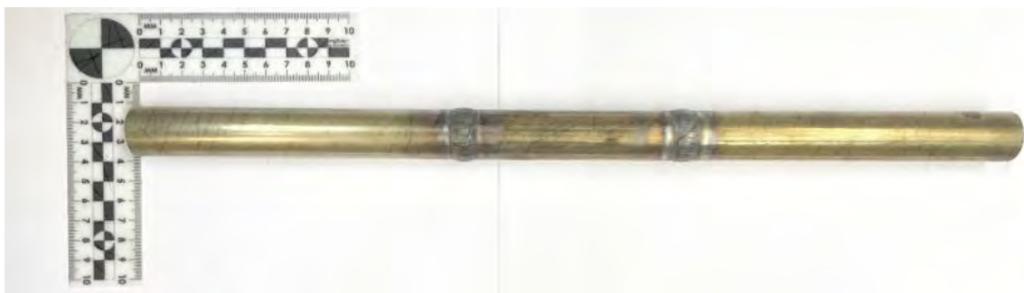
Рис. 1. Фотография сварного образца для проведения испытаний
