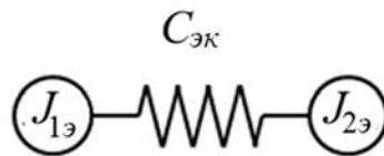
Рисунок 6 – Двухмассовая консервативная расчетная схема механической части ЭП
