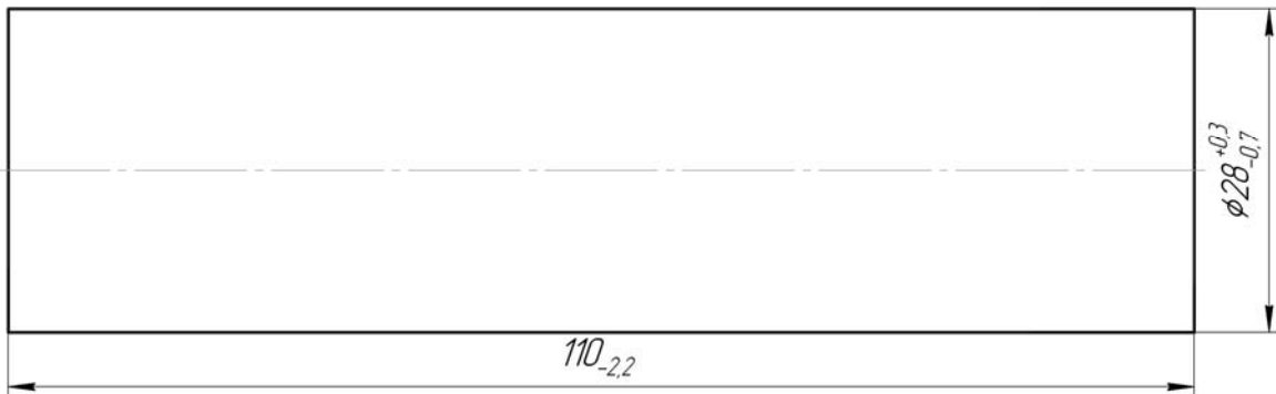
Рисунок 3.1 – Параметры заготовки после отрезной операции
