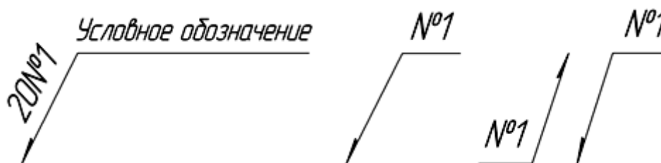
Рисунок 1.12 – Обозначение одинаковых сварных швов
