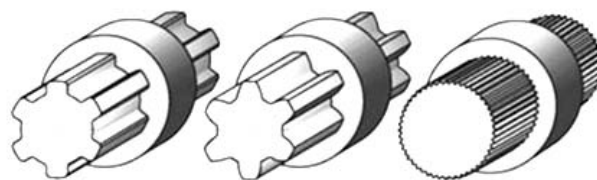
Рисунок 6.5 – Профиль зубьев шлицевого соединения
