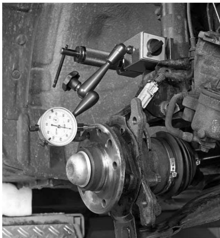
Рисунок 10.6 – Проверка допуска плоскости ступицы колеса на биение [9]
