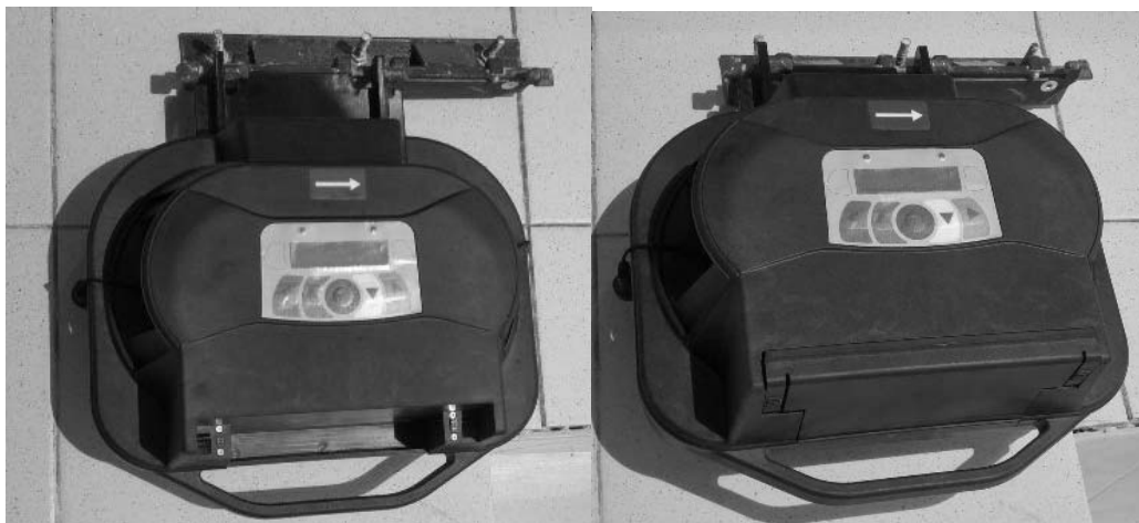
Рисунок 8.4 – Установка аккумуляторов на лазерные головки
