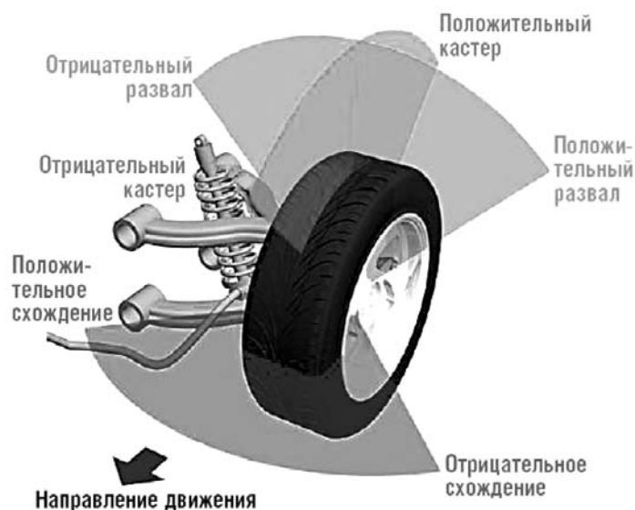
Рисунок 8.6 – Углы установки управляемых колес автомобиля
