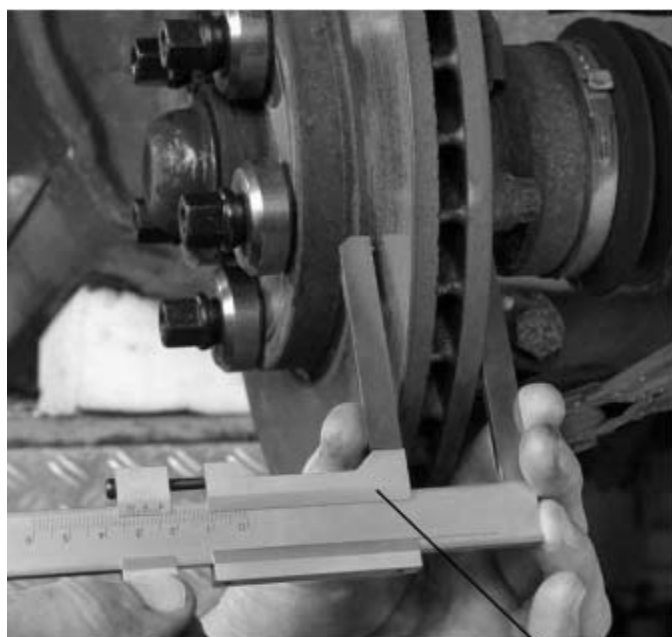
Измерение износа тормозного диска
