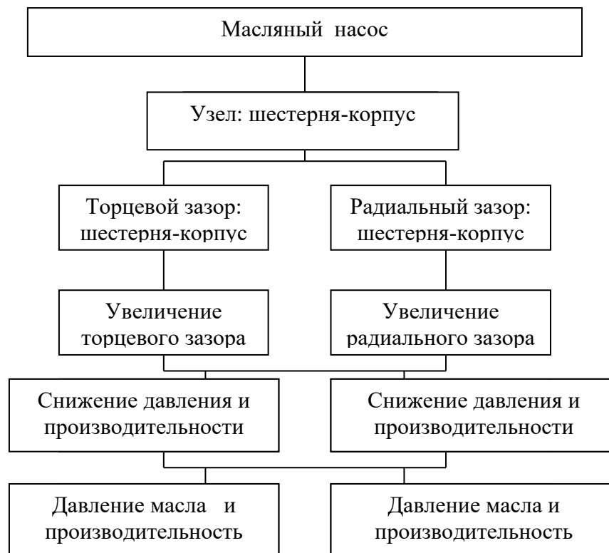
Рисунок 1.1 – Структурно-следственная модель масляного насоса (фрагмент)
