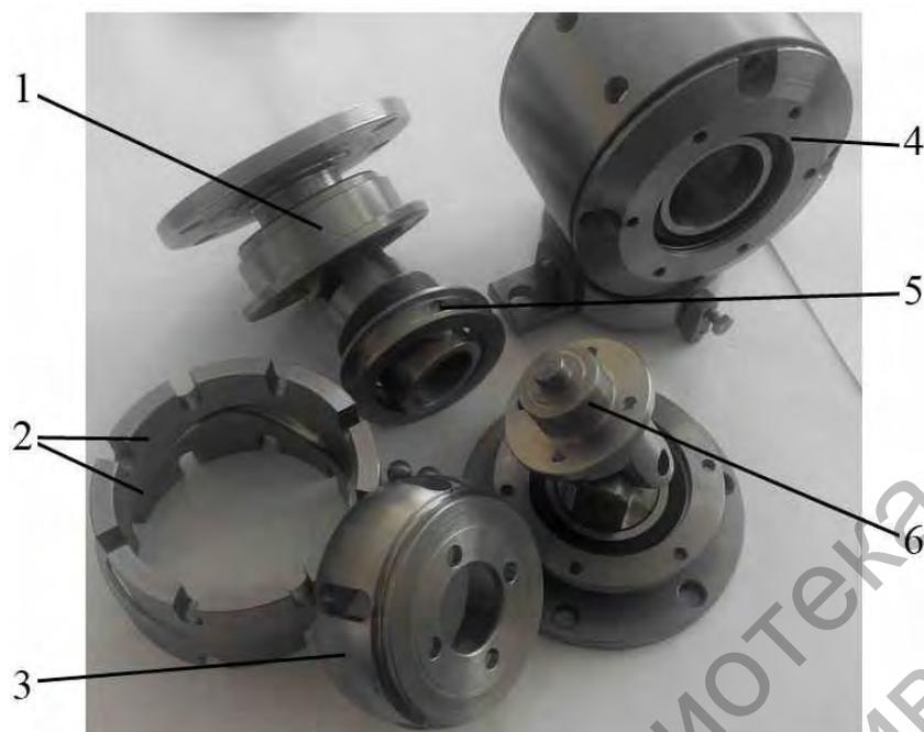
1 – ведущий вал с фланцем, шарниром и крышкой; 2 – наружные сферические кулачки, образующие беговую дорожку; 3 – сепаратор; 4 – корпус; 5 – внутренний кулачок; 6 – ведомый вал, присоединяемый к сепаратору с шарниром, крышкой и фланцем
