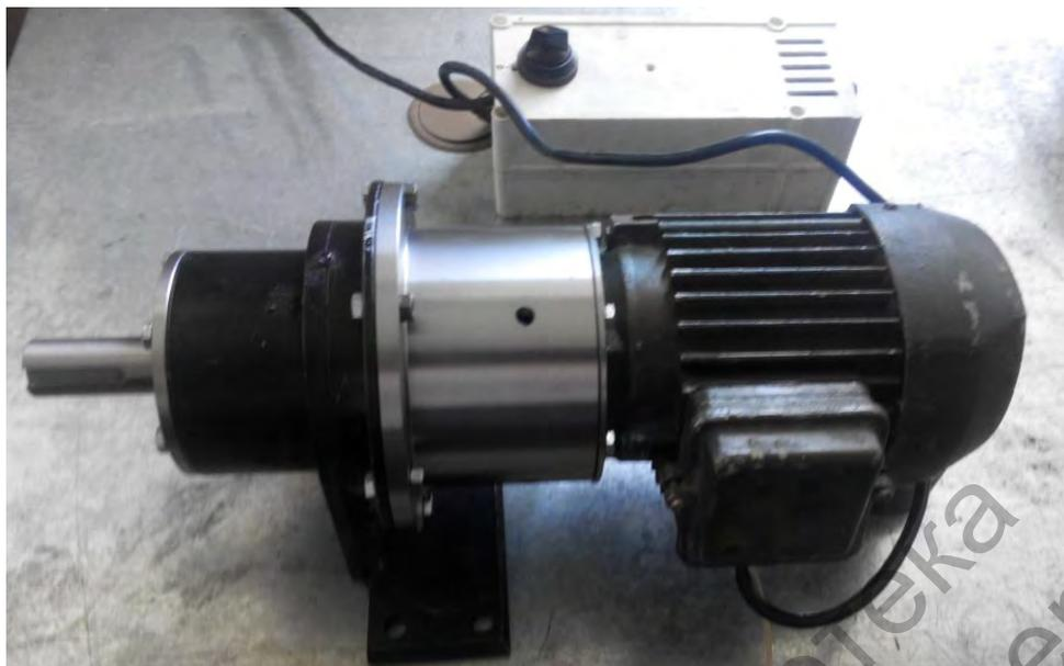
Рисунок 6.6 – Мотор-редуктор с пультом управления
