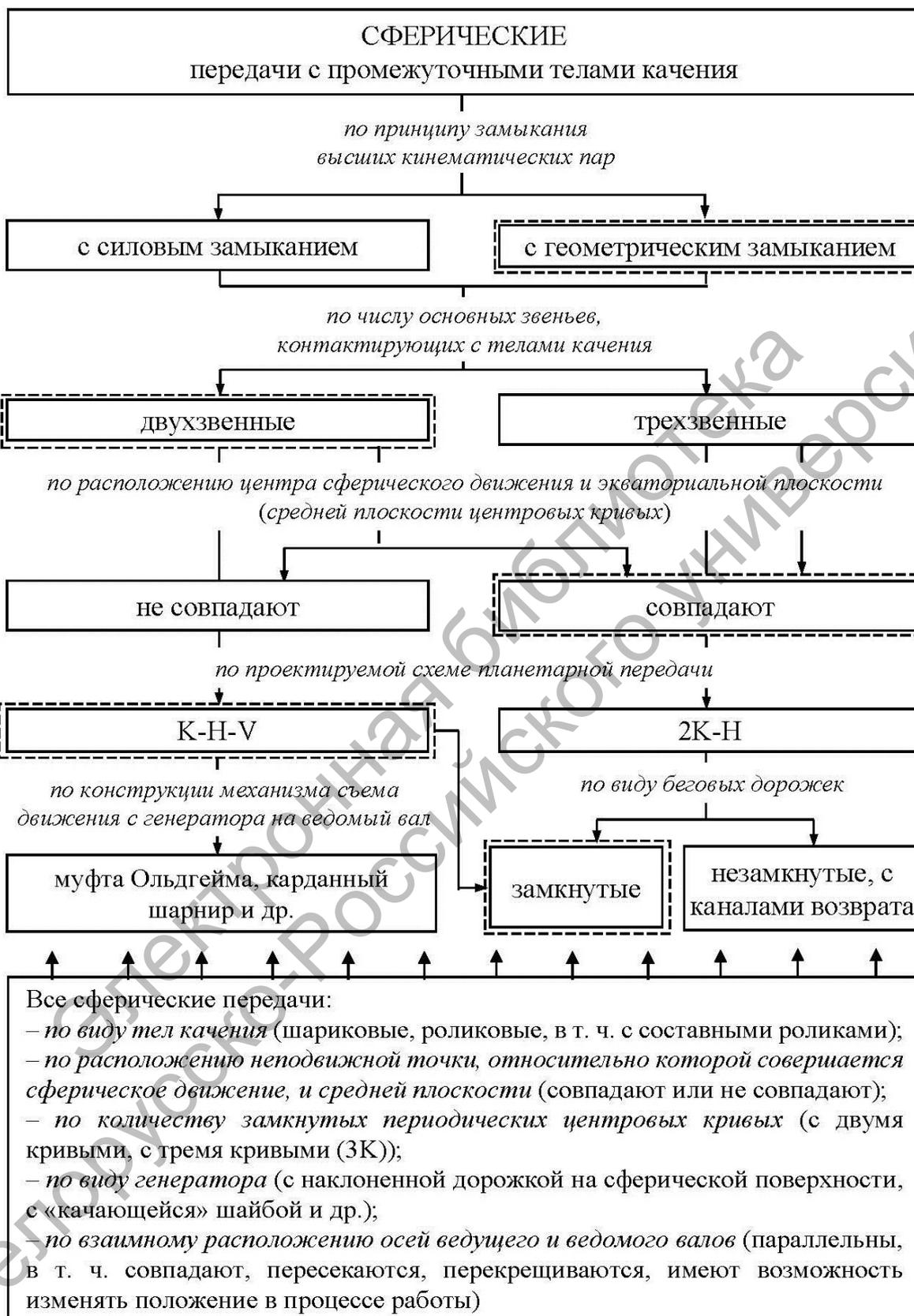
Рисунок 1.16 – Классификационная схема СППТК
