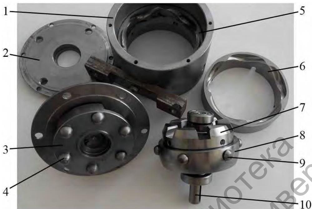
1 – корпус; 2 – входная крышка; 3 – ведомая полумуфта с выходной крышкой и ведомым валом; 4 – сферические выступы угловой муфты; 5, 6 – наружные сферические кулачки, образующие беговую дорожку; 7 – ведущая полумуфта с профильными пазами; 8 – генератор; 9 – ролики; 10 – ведущий вал
