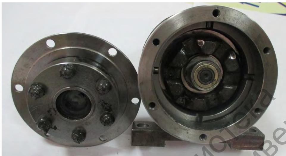
Рисунок 5.20 – Характер повреждений разработанной угловой муфты двухзвенной СРП
