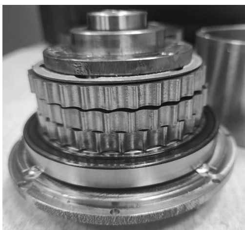
Рис. 1. Экспериментальный образец ЦЦПП: ведущий вал (водило) с установленными на эксцентриках сателлитами (а); центральное колесо ЦЦПП с внутренними зубьями с круглым профилем (б)
