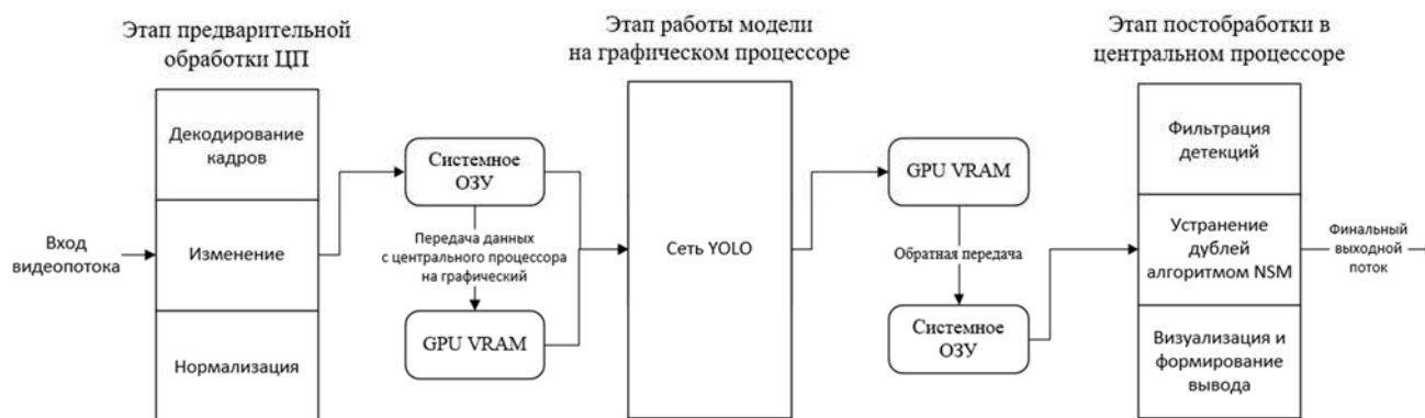
Рис. 1. Схема потока данных и накладных расходов нейросетевых моделей семейства YOLO
