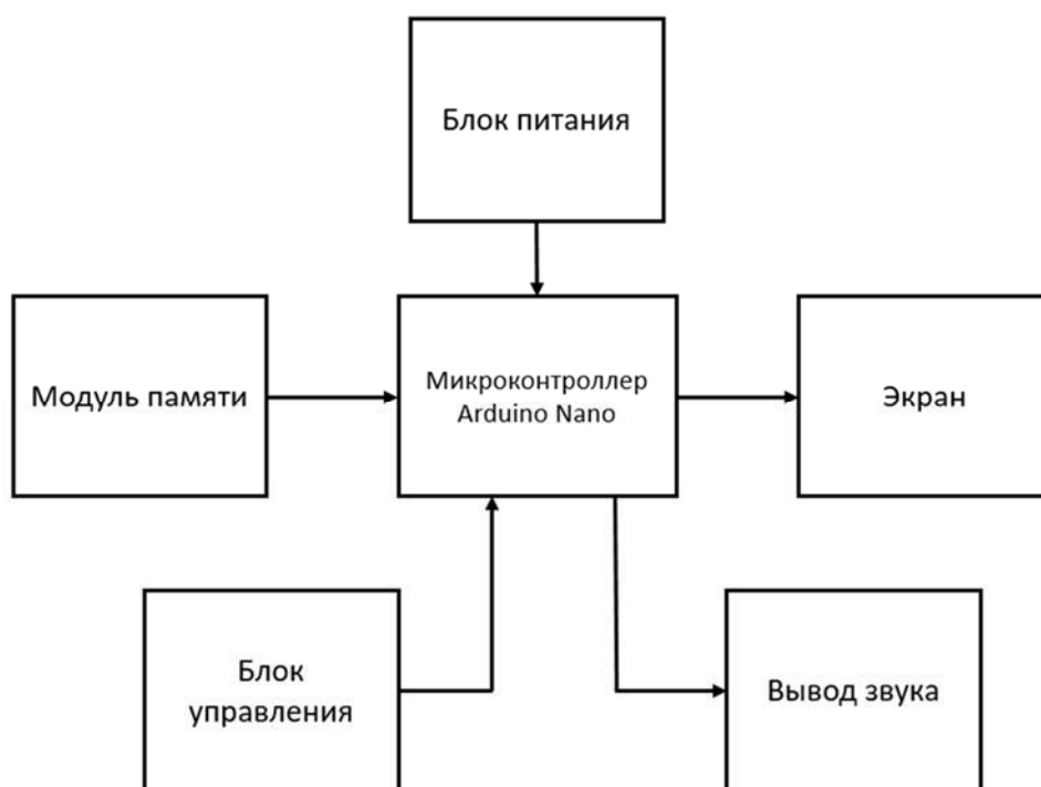
Рис. 1. Структурная схема технических средств таблетницы
