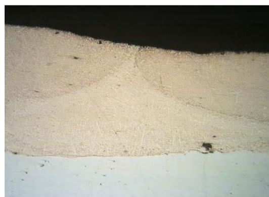
Рис. 2. Поперечное сечение полосчатого покрытия из сплава x50
