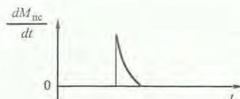
Рис. 4. Импульс напряжения на выходе дифференцирующей цепи
