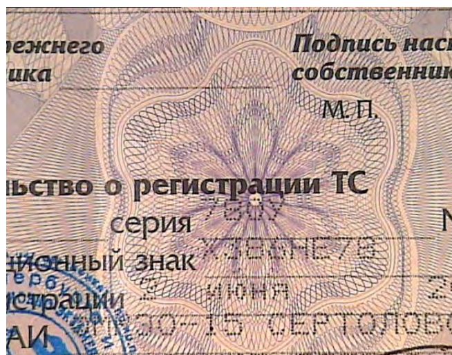
Рис. 14. Гильоширный узор, розетка и ирисная печать на свидетельстве о регистрации транспортного средства
