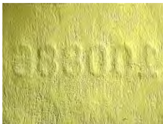
Рис. 10. Номер железнодорожного билета, выполненный методом высокой печати, слева – лицевая сторона, справа – оборотная, на которой видны продавленные цифры
