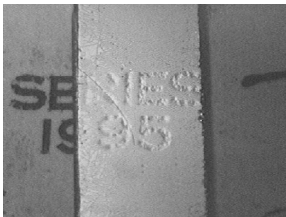
Рис. 21. Фрагмент магнитооптической визуализации наличия магнитных частиц в краске, которой напечатано обозначение серии на 100-долларовой банкноте
