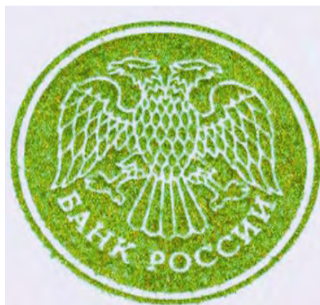
Рис. 23. Фрагмент банкноты напечатанной OVI-краской под разными углами наблюдения
