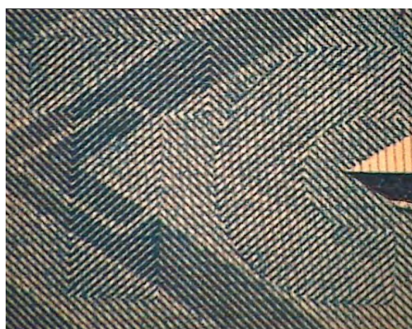
Рис. 16. Защитный элемент «корро»: при небольшом увеличении центральной части предыдущего фрагмента становятся видными буквы «ПТС» (в данном случае «ТС»)
