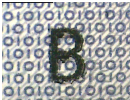
Рис. 11. Номер десятирублёвой банкноты, выполненный высокой печатью и его увеличенный фрагмент, на котором чётко виден натиск краски
