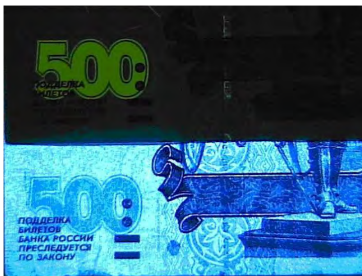
Рис. 2. Подлинная (сверху) и поддельная (снизу) 500-рублёвая купюра в ультрафиолетовых лучах 313 нм.
