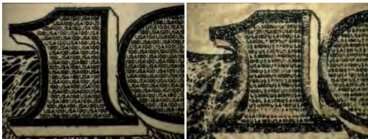
Рис. 18. Фрагменты подлинной (а) и поддельной (б) 100-долларовой банкноты с микротекстом
