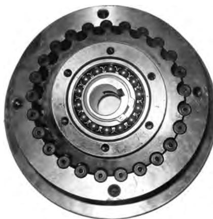
Рис. 12.17. Детали прецессионного редуктора для привода бетонозаглаживающей машины
