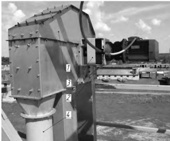
Рис. 12.21. Общий вид привода ковшового элеватора: 1 – голова нории; 2 – мотор-редуктор; 3 – рама привода; 4 – разгрузочный патрубок
