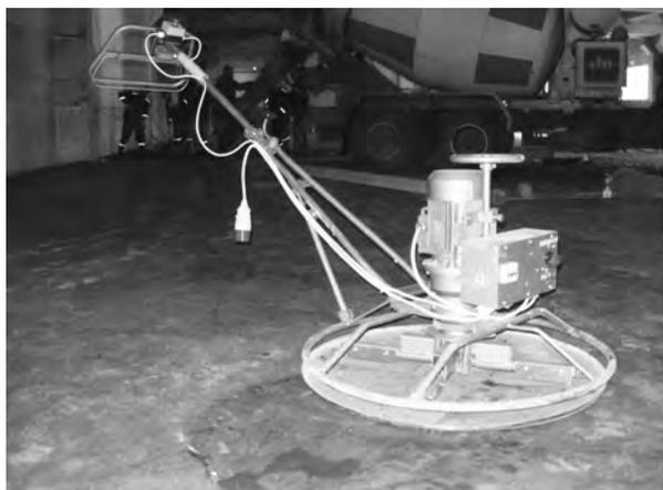
Рис. 12.18. Заглаживающая машина СО-170 с прецессионным мотор-редуктором с коническими роликами
