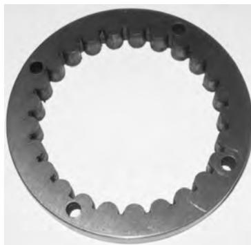
Рис. 12.13. Центральное колесо с внутренними зубьями круговой формы
