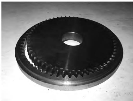
Рис. 12.10. Общий вид зубчатых колес прецессионной передачи
