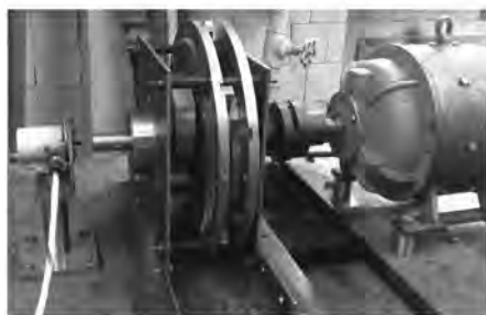
Рис. 13.3. Зубчатая планетарная плавно регулируемая передача: a – структурная схема: 1 – механизм регулирования передаточного отношения, 2 – механизм исключения поломок и компенсации погрешности угла поворота сателлита, 3 – механизм балансировки неуравновешенных масс, 4 – механизм съема вращения с сателлита; б – центральное зубчатое колесо и вспомогательная планетарная передача; в – противовесы механизма балансировки сателлита (справа)
