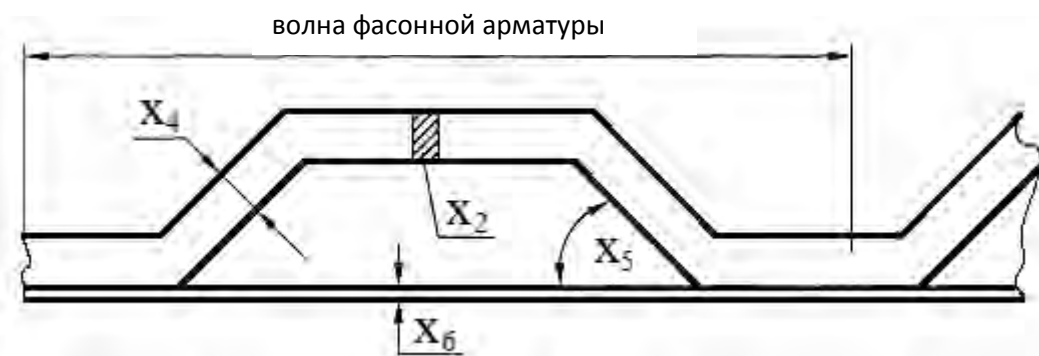
Рисунок 2.10 – Конструктивные размеры металлической составляющей КНЭСК
