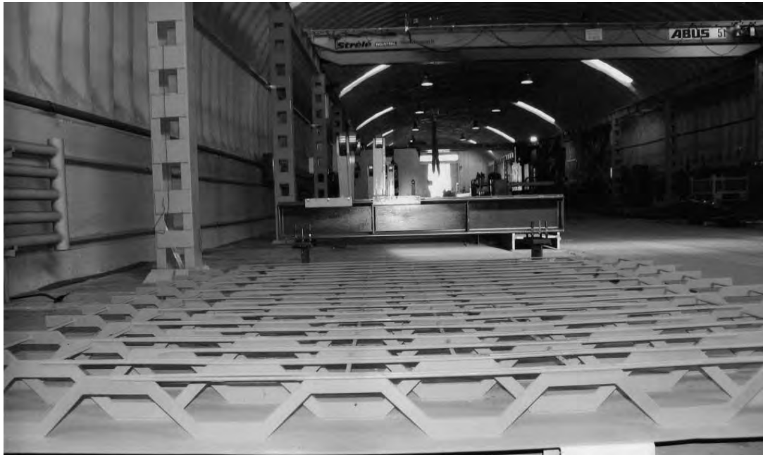
Рисунок 2.53 – Опытный образец КНЭСК (март 2012 г.) для второй очереди путепровода в г. Гомеле (ул. Полесская)
