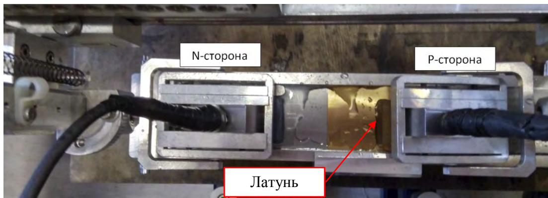
Рис. 4. Измерение эхосигналов для латунного имитатора сварного соединения
