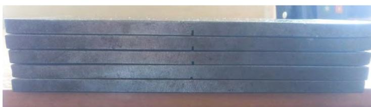
Рис. 1. Тест-образцы с искусственными отражателями в виде пазов
