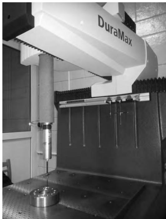
Рисунок 4.36 – Измерение смещений осей обрабатываемых отверстий на координатно-измерительной машине DuraMax 5/5/5 фирмы «Карл Зейс» (Carl Zeiss)
