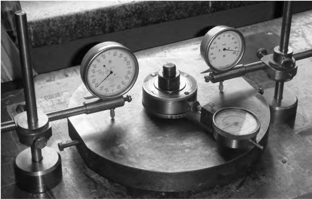
Рисунок 2.7 – Установка для определения смещений заготовки под действием сил закрепления при базировании по плоскости
