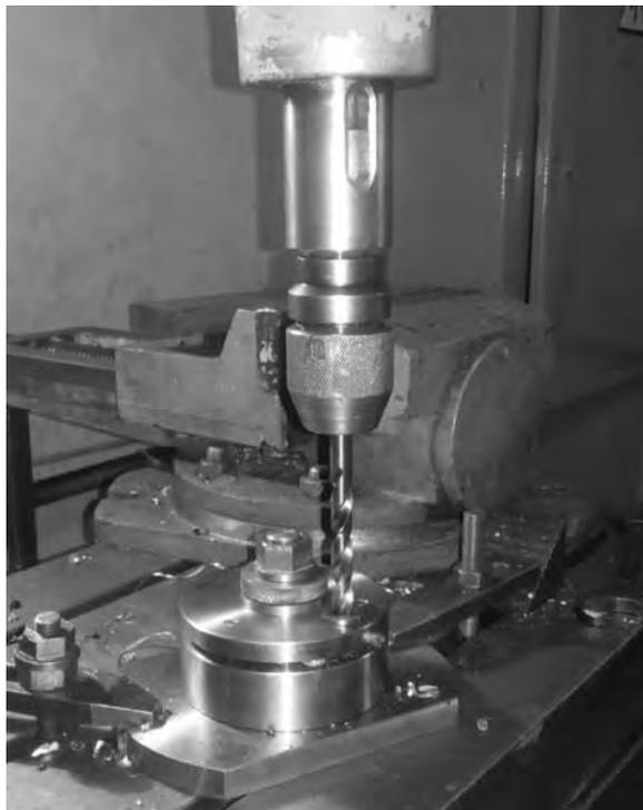
Рисунок 4.34 – Кондуктор для исследования процесса сверления отверстия  $\varnothing 10$  мм
