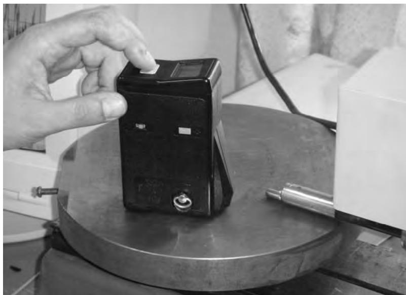
Рисунок 2.11 – Измерение твердости заготовки твердомером ТПЦ-4
