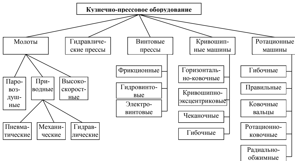
Рис. 7.2. Классификация кузнечно-прессовых машин
