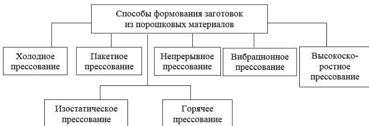
Рис. 16.2. Классификация основных способов формования заготовок из порошковых материалов
