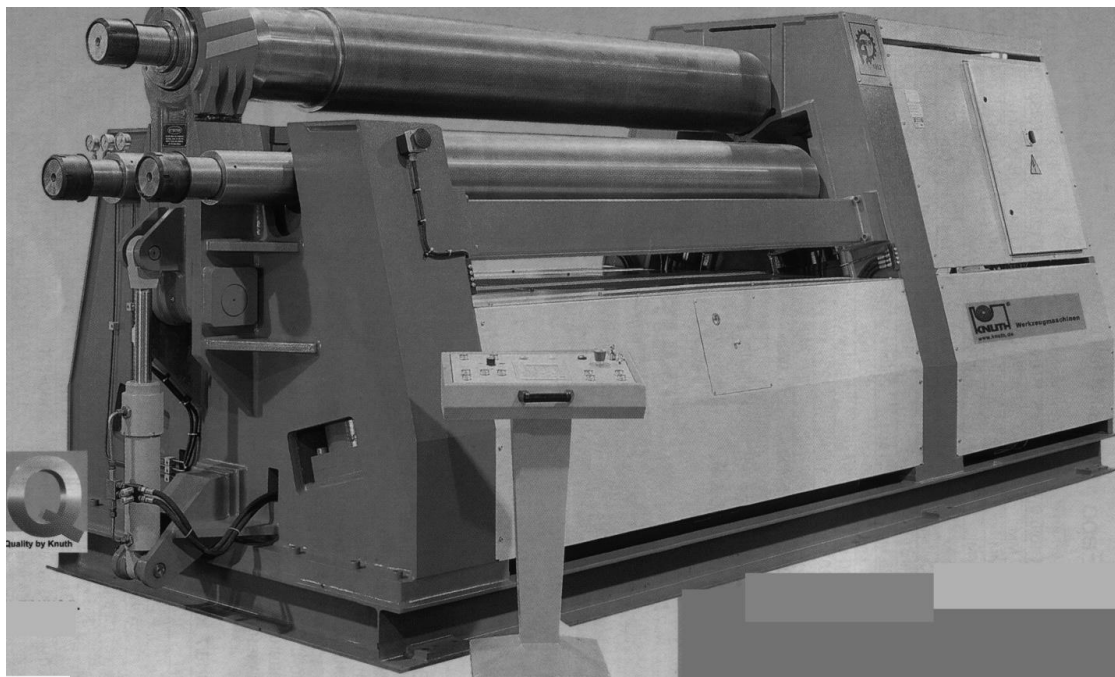
Рис. 13.5. Ротационная трехвалковая гидравлическая гибочная машина для изготовления тонкостенных труб
