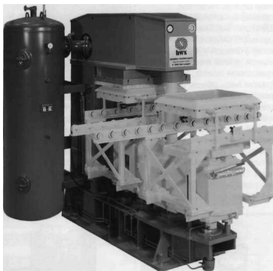
Рис. 4.7. Общий вид и технические характеристики формовочной машины типа HSP мод. 4841
