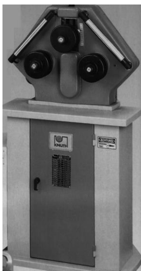
Рис. 13.6. Общие виды листогибочных машин: а – сортогибочная машина; б – гидравлическая круглогибочная машина
