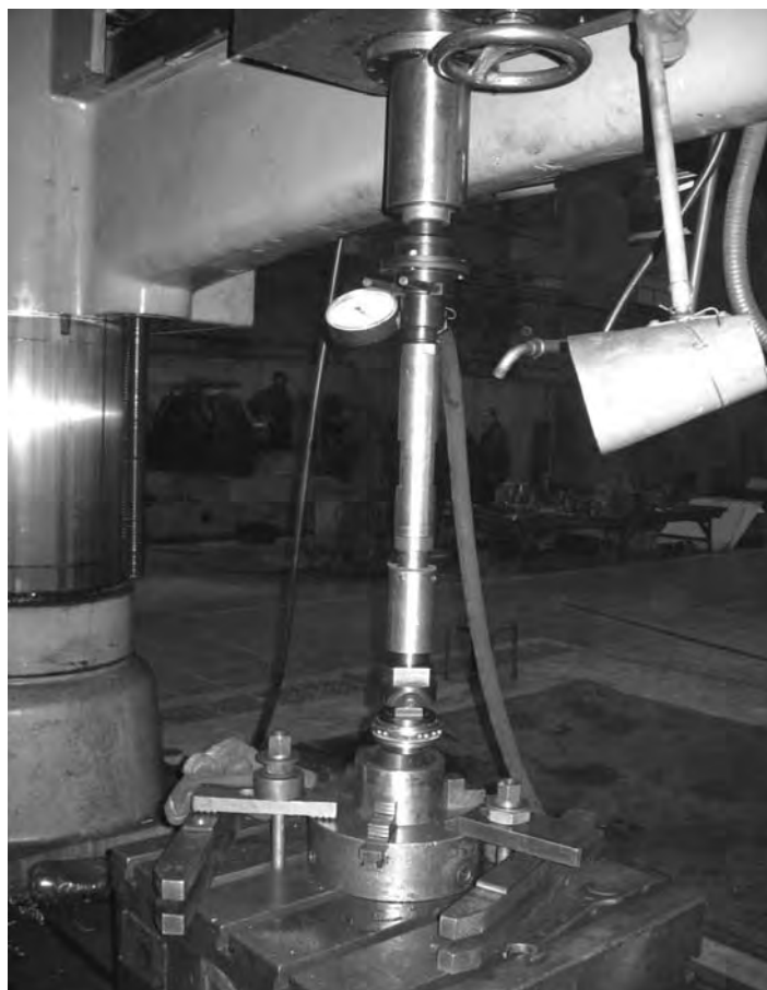
Рисунок 7.1 – Технологическое оснащение процесса суперфинишной ПЦО с вертикальной подачей инструмента при неподвижной заготовке
