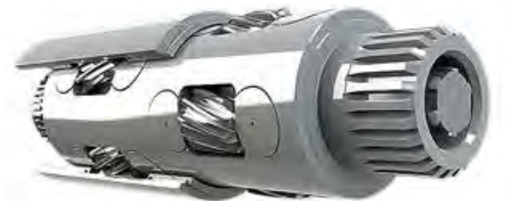
Рисунок 1.3 – Редукторная вставка турбобура на основе двухсекционной планетарной зубчатой передачи с зацеплением Новикова (ВНИИБТ, Российская Федерация)
