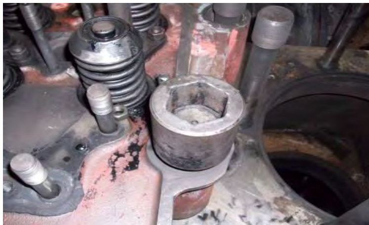
Рисунок 1.5 – Резьбовое соединение, крепящее головки цилиндров дизельных двигателей тепловозов ЧМЭ-3
