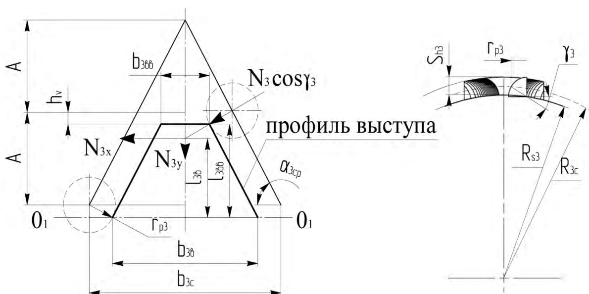
Рисунок 3.2 – Схема для расчета выступов кулачка, закрепленного в корпусе, по напряжениям изгиба
