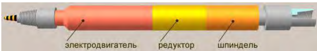
Рисунок 1.2 – Схема электробура с редуктором-вставкой
