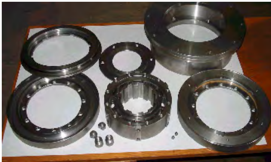
Рисунок 6.12 – Элементы конструкции нового дискового тормоза полуприцепа МАЗ с устройством измерения тормозного момента
