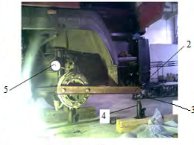
1 – оси колодок тормоза с электронным датчиком; 2 – нагрузочный рычаг; 3 – динамометр сжатия; 4 – домкрат; 5 – манометр давления воздуха в приводе тормоза
