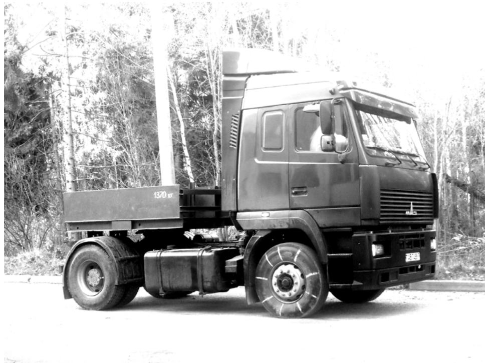
Рисунок 4.46 – Объект испытаний MAZ-544018-320-030 (двигатель DAIMLER CHRAYSLER–ЕВРО-3) с устройством измерения тормозного момента, включенного в барабанные тормоза колес передней оси
