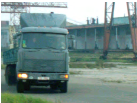
Рисунок 4.54 – Седельный автопоезд в составе тягача МАЗ-64229 и полуприцепа МТМ 9330 с устройством измерения сил в сцепке на испытаниях
