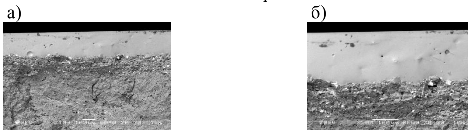
Рис. 1. Электронный снимок со скола образца с бездефектной поверхностью (увеличение \times 200 (а); \times 1000 (б))
