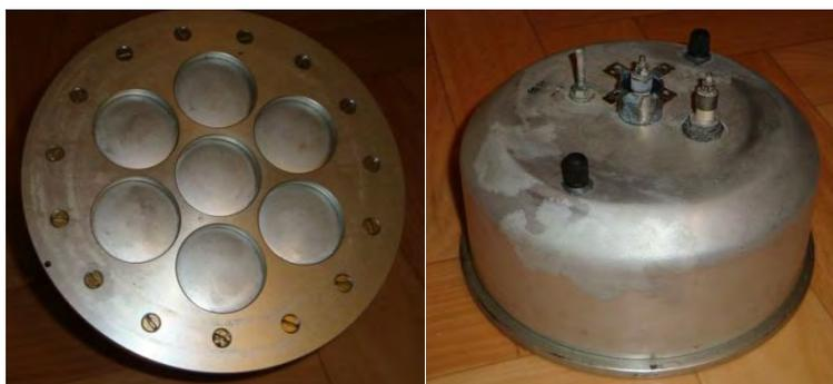
Рис. 2. Газонаполненная аргоно-ксеноновая ионизационная камера
