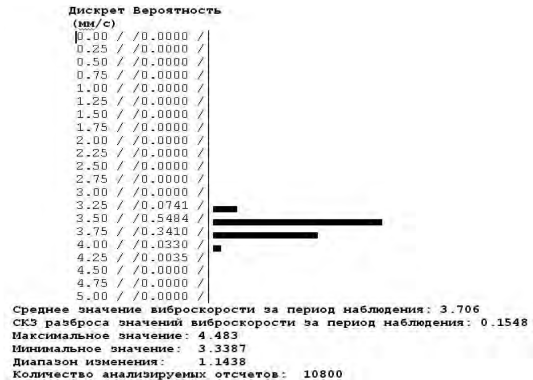
Рис. 3. Результаты обработки суточного временного тренда СКЗ виброскорости подшипника генератора при его нормальной работе
