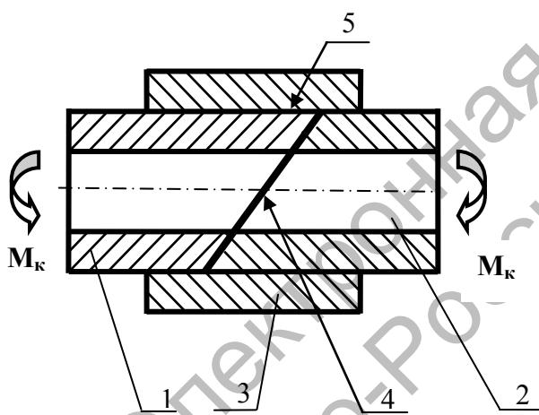
1, 2 – соединяемые трубы; 3 – муфта; 4 – косой стык; 5 – паяный шов.
