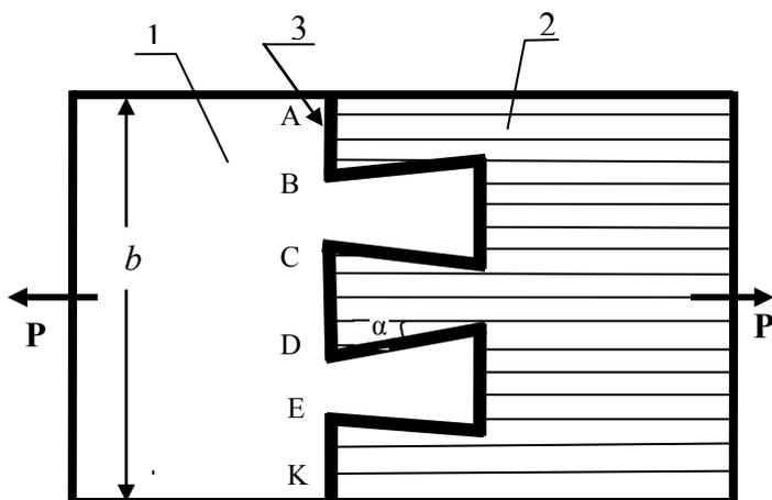
Рисунок 2 – Схема стыкового паяного соединения замкового типа
