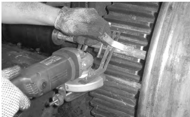
Рисунок 8 – Корректировка профилей зубьев ведомого зубчатого колеса КМБ локомотива ЧМЭЗ
