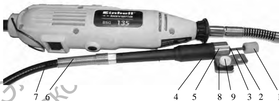
Рисунок 6 – Принцип устройства «Радиусомер для активной поверхности зуба эвольвентной передачи»
