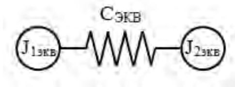
Рисунок 16 – Двухмассовая консервативная расчётная схема механической части ЭП
