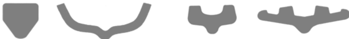
Рис. 2. Формы поперечного сечения плиц гусениц
