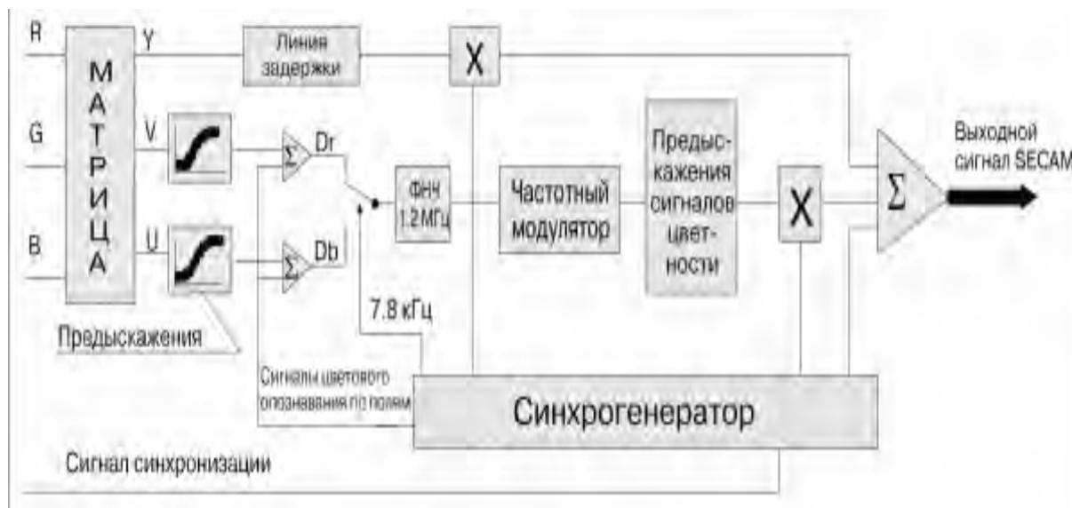
Рисунок 8.13 – Кодер SECAM
