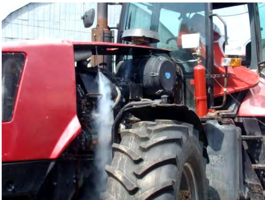
Рис. 1. Проверка работоспособности установки газового пожаротушения
