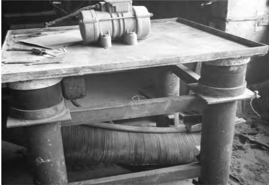
Рисунок 3.23 – Промышленный пружинный грохот
