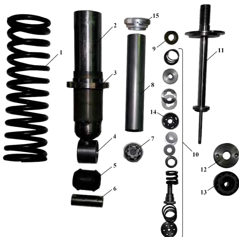
1 – цилиндрическая пружина; 2 – резервуар амортизатора в сборе; 3 – гайка пружины; 4 – проушина; 5 – резиновая втулка; 6 – втулка шарнира; 7 – клапан сжатия в сборе; 8 – цилиндр; 9 – буфер хода отбоя; 10 – детали поршневого узла; 11 – шток в сборе; 12 – гайка резервуара; 13 – сальник штока; 14 – поршень; 15 – направляющая втулка Рисунок 9. – Конструкция опытного демпфера системы поддрессоривания кабины колесного трактора
