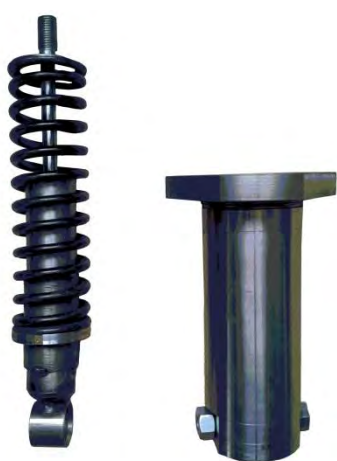
Рисунок 8. – Внешний вид кронштейна и опытного демпфера в сборе
