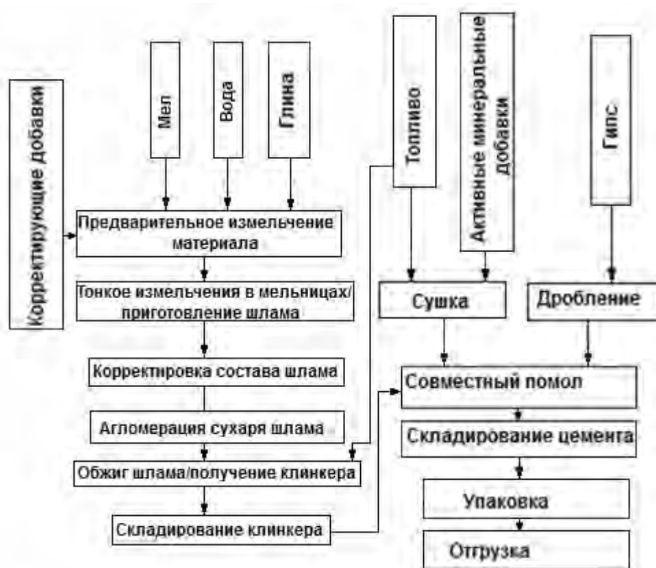
Рисунок 3 – Принципиальная технологическая схема получения портландцемента комбинированным способом
