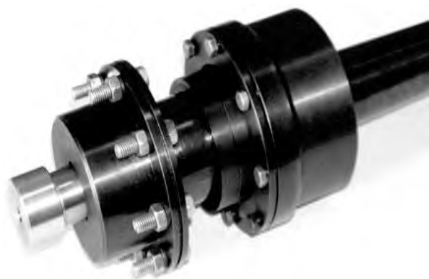
Рис. 4. Устройство для упрочняющей обработки выглаживанием наружных поверхностей валов (а). Фотография обработанной детали (б)
