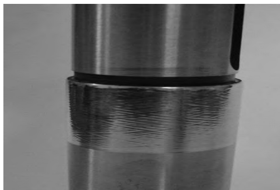
Рис. 4. Устройство для упрочняющей обработки выглаживанием наружных поверхностей валов (а). Фотография обработанной детали (б)
