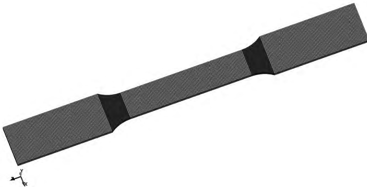
Рис. 9. Конечно-элементная модель образца материала сталь EN 1.4003
