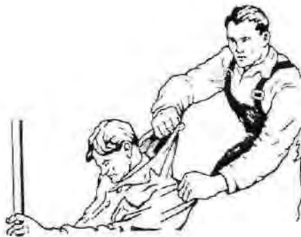
Рисунок 2.3 – Освобождение пострадавшего от тока для ЭУ напряжением до 1000 В отгаскиванием за сухую одежду
