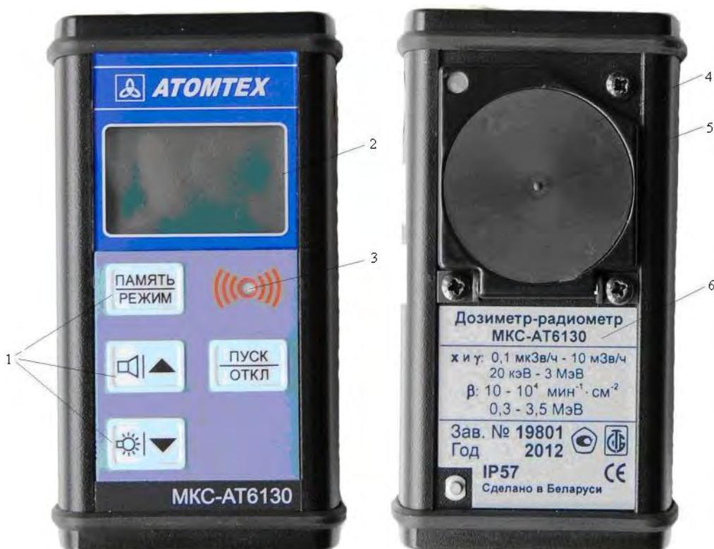
1 – мембранная панель управления; 2 – жидкокристаллический индикатор (ЖКИ); 3 – светодиодный индикатор; 4 – крышка-фильтр с магнитным фиксатором; 5 – метка центр детектора; 6 – этикетка с характеристикой прибора
