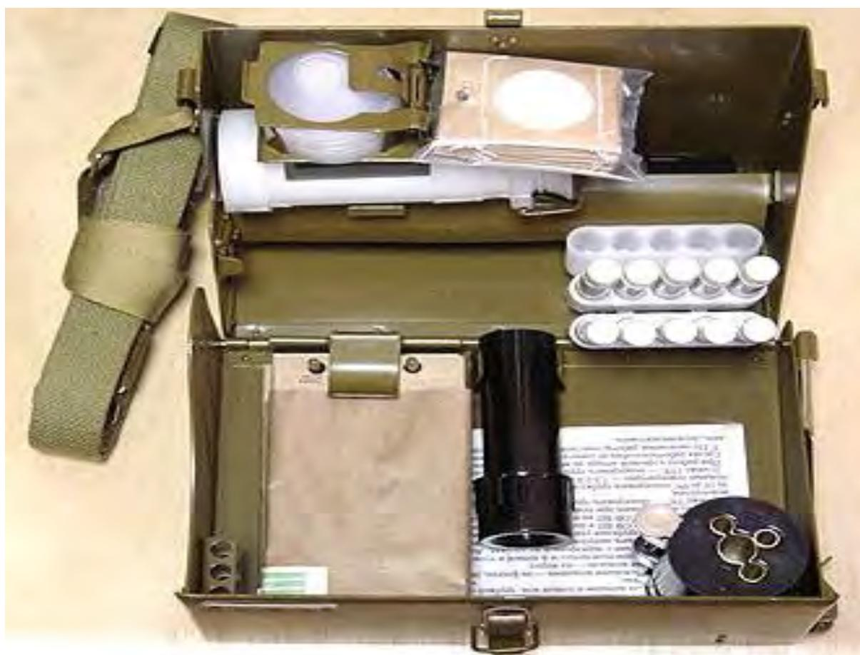
Рисунок 1.1 – Войсковой прибор химической разведки
