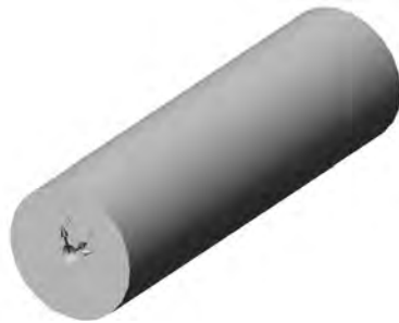
Рисунок 2.26 – Модель заготовки с центровыми отверстиями
