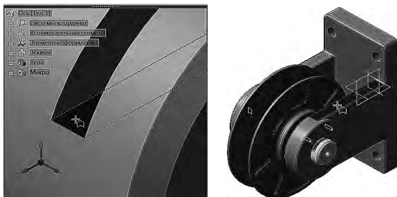
Рисунок 4.5 – Придание параллельности деталям «Ось» и «Вилка»
