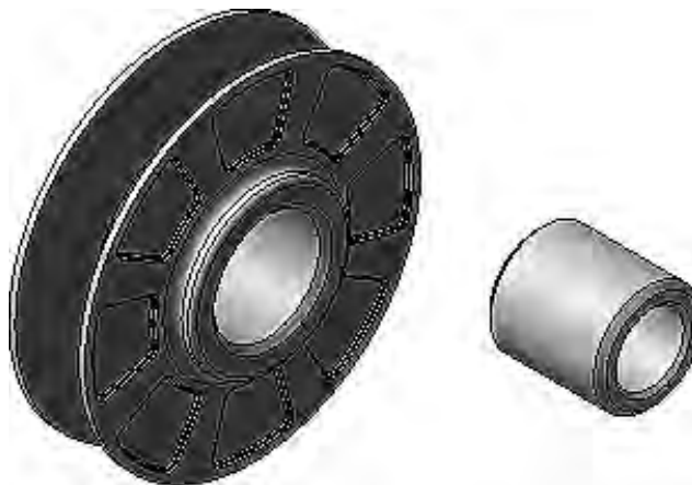
Рисунок 3.2 – Добавление в сборку деталей «Ролик» и «Втулка»
