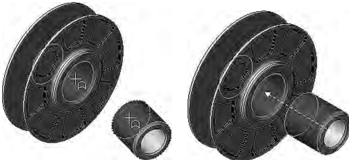
Рисунок 3.3 – Придание соосности деталям «Ролик» и «Втулка»
