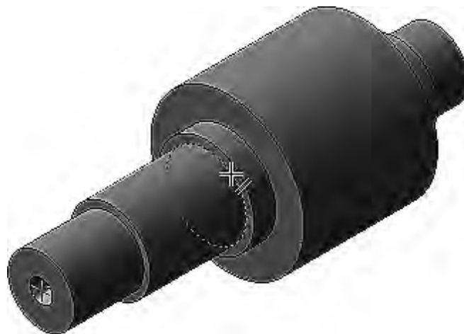
Рисунок 10.8 – Указание ребра в месте построения канавки
