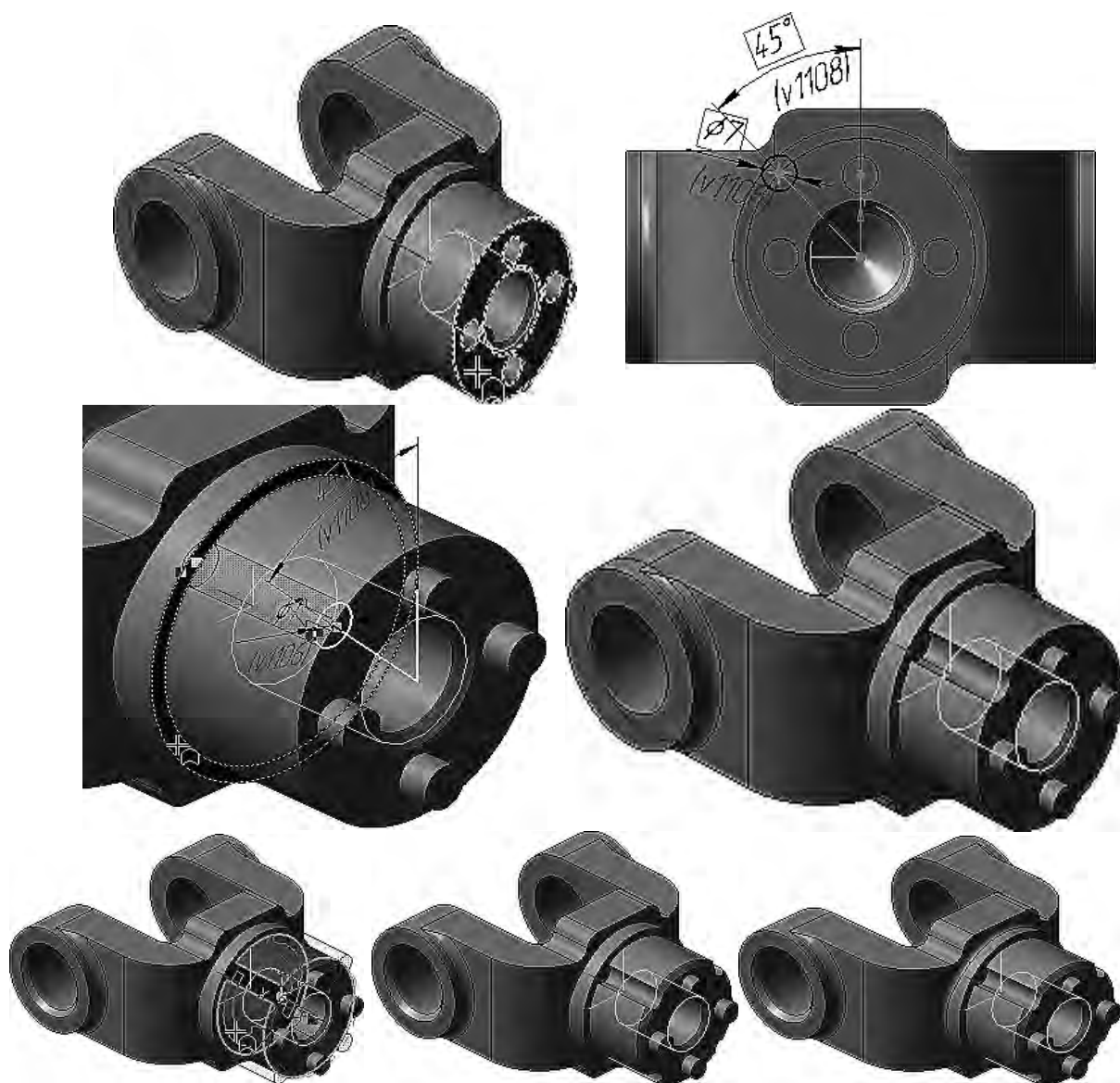
Рисунок 1.16 – Построение четырех канавок, фасок и скруглений
